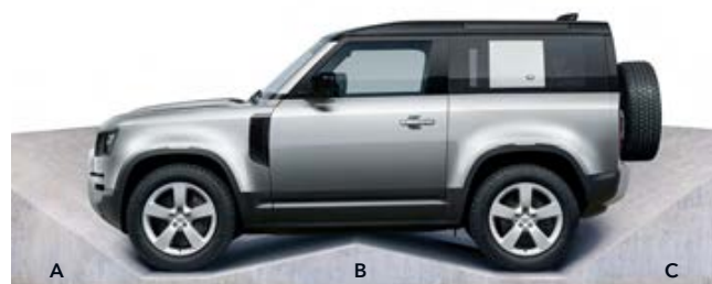
4 583 mm A B C Rampas leņķis tuvošanās leņķis bremzēšanas leņķis izlidošanas leņķis Off-Road* - Pneimatiskā balstiekārta 31,5° (38,0°) 25,5° (31,0°) 35,5° (40,0°) Standard - Atsperu balstiekārta 31,0° (30,1°) 25,0° (24,2°) 37,9° (37,6°) Brodošanas dziļums: atsperu balstiekārta 850 mm, pneimatiskā balstiekārta 900 mm
