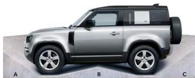
Rampas leņķi A B C tuvošanās leņķis 31,5° (38,0°) 25,5° (31,0°) 35,5° (40,0°) bremzēšanas leņķis 31,0° (30,1°) 25,0° (24,2°) 37,9° (37,6°)
