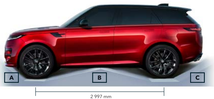
Rampas leņķis A tuvošanās leņķis 33,0° / 30,0° B bremzēšanas leņķis 26,09° C izlidošanas leņķis 30,0°
