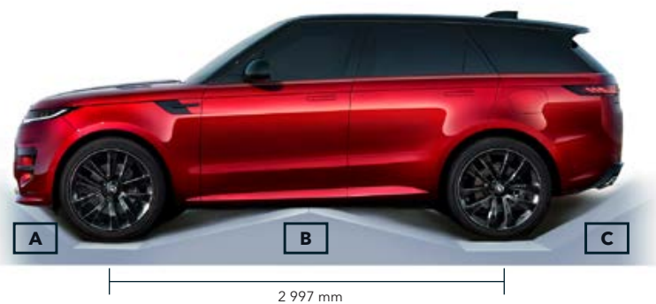
A Rampas leņķi B tuvošanās leņķis 33,0° / 30,0° C bremzēšanas leņķis 26,09° izlidošanas leņķis 30,0°
